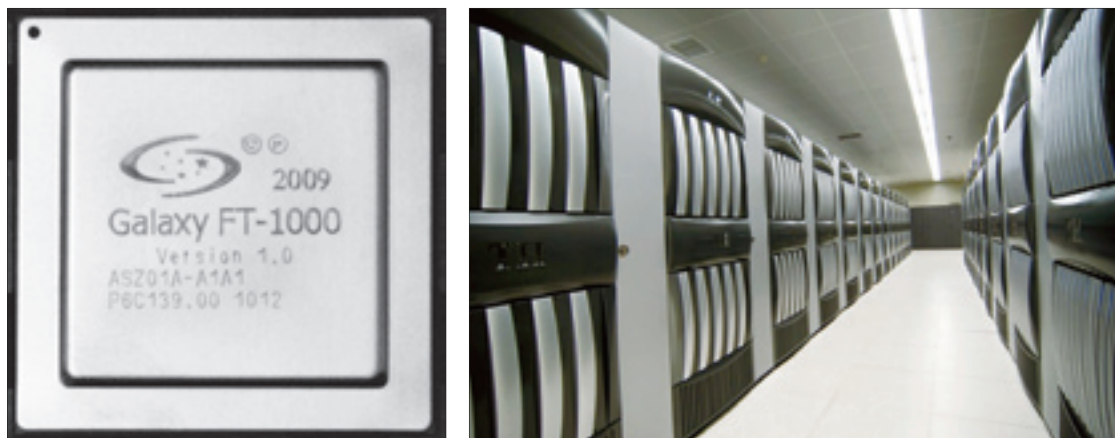
图 5-3 高性能多核 CPU 芯片 FT-1000 成功应用于“天河一号”超级计算机系统
