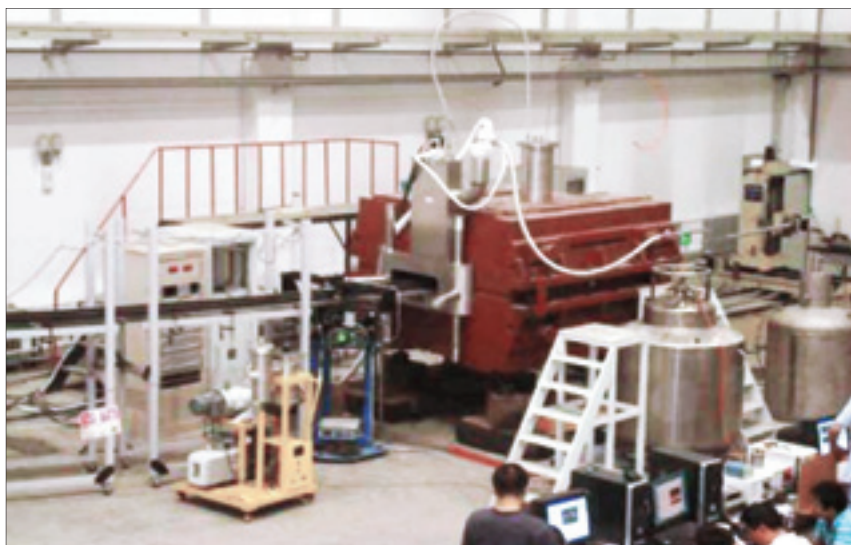
图 14-2 中国科学院近代物理研究所、等离子体研究所和电工研究所联合研制的 Super-FRS 超导二极磁铁样机
