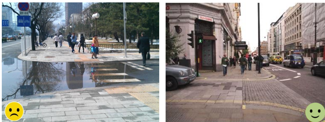
图 12.4.1 机动车出入口设计反例与正例
