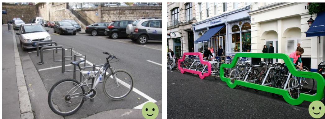
图 12.3.5 路侧停车带设置自行车停车设施正例
