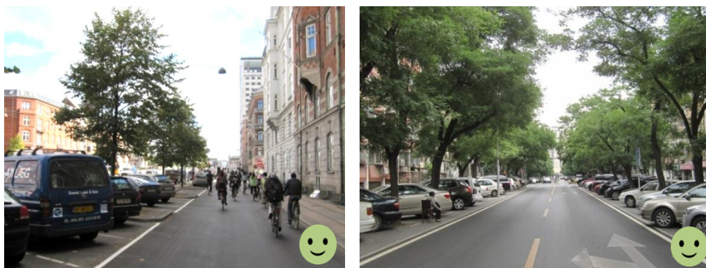
图 12.3.4 路侧停车泊位结合机非隔离带布置正例
