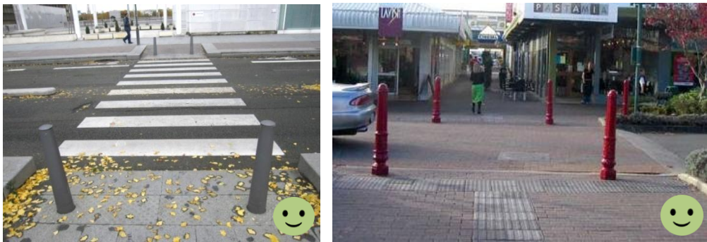
图 5.4.3 人行横道阻车桩设置正例
