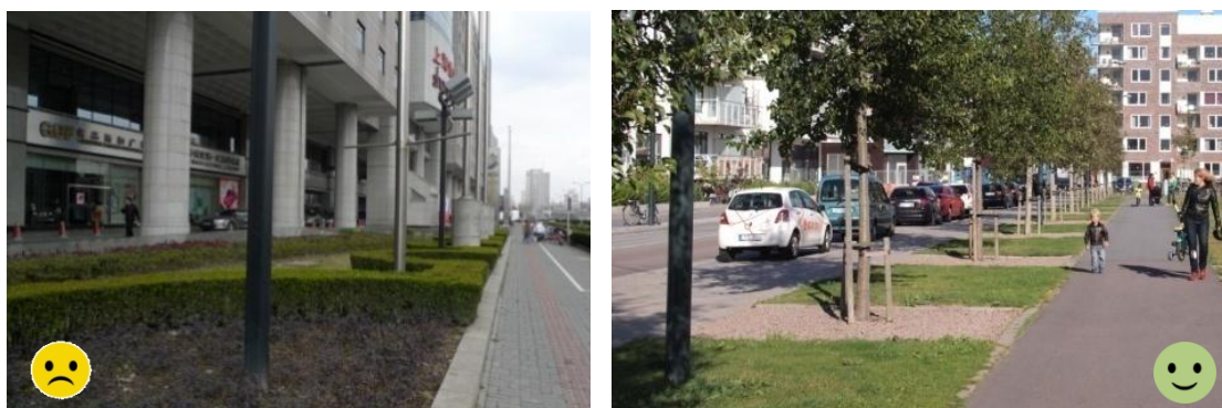
图 6.3.4 绿化带设置反例（绿化带阻隔行人穿越）与正例
