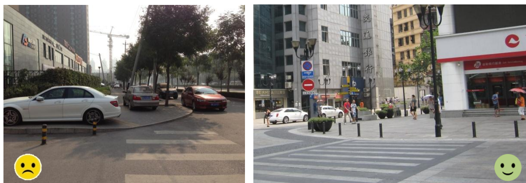
图 5.5.2 交叉口转角设置阻车桩反例与正例
