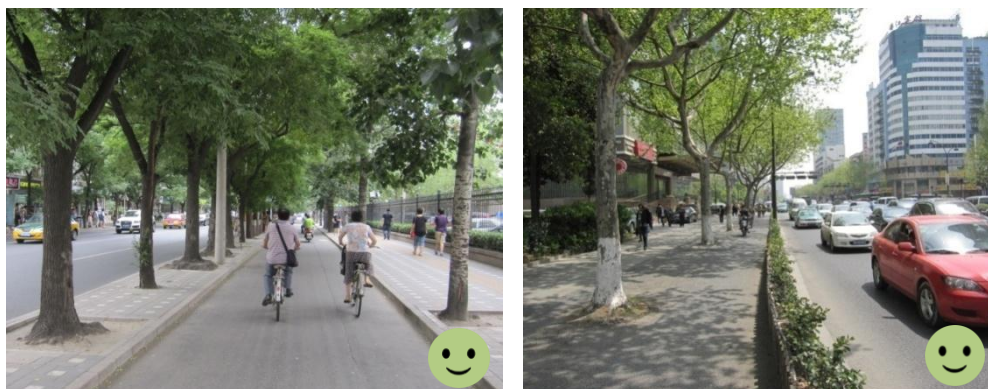
图 8.2.1 - 1 自行车道采用机非物理隔离正例
