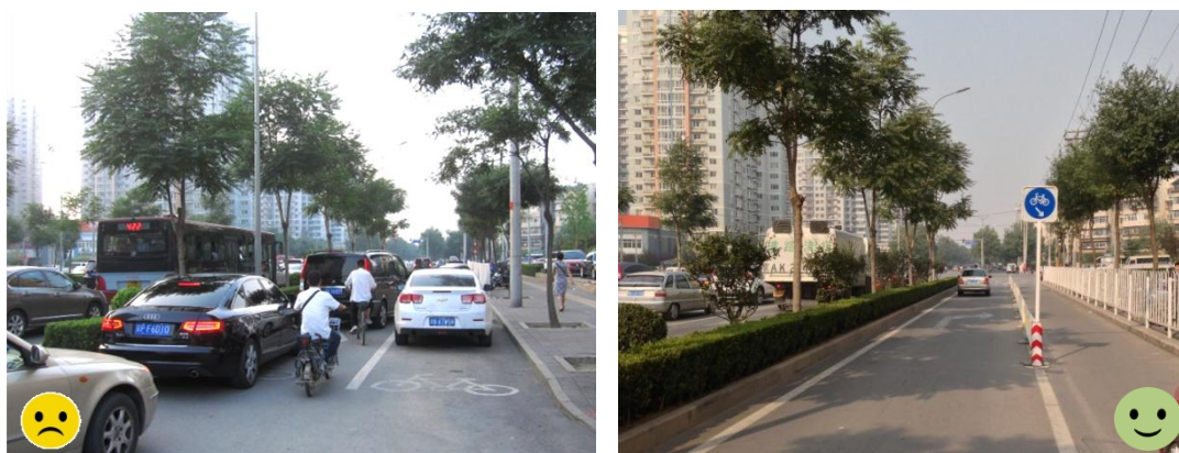
图 12.2.1 机动车道路辅路机非物理隔离反例与正例
