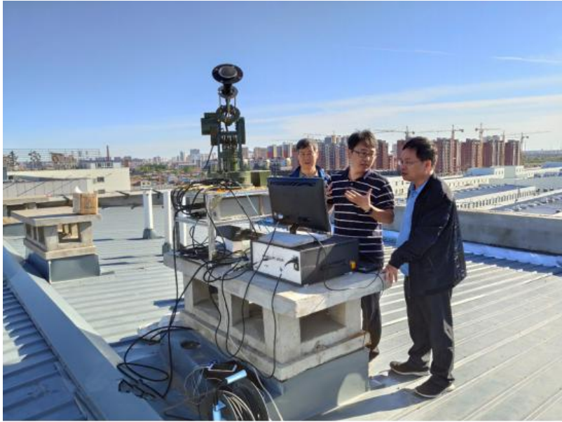
图 2-3 海洋二号 B 星散射计有源定标器外场定标试验现场
