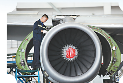
南航机务正在清洗发动机
