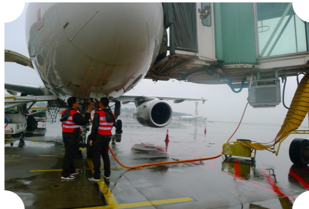
重庆机场 APU 替代设施
